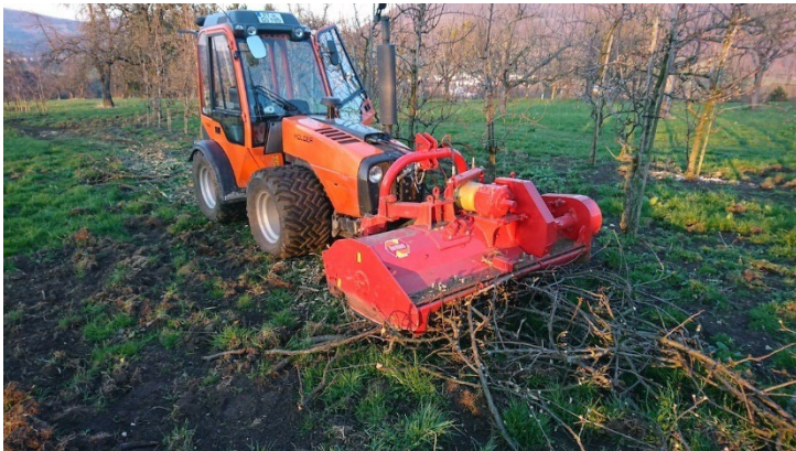
Abb. 19: Schlegelmulcher im Einsatz.
